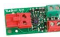
Interfaccia BUS XIB (per scheda E045 o E024S con fotocellula no BUS)
