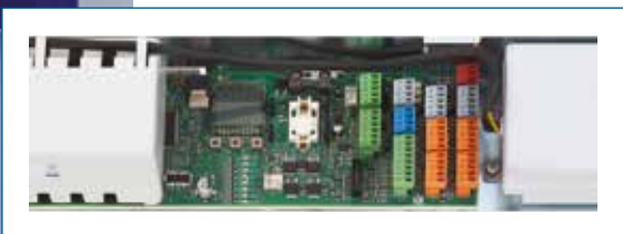
Unità di controllo con alimentatore switching
