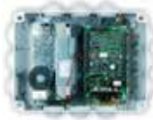
Unità di controllo online in contenitore plastico. Alim. 230 Vca
